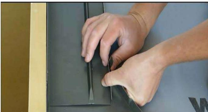
3. Unire il fondo e i raccordi laterali (dx e sx) con l'apposita linguetta metallica.
