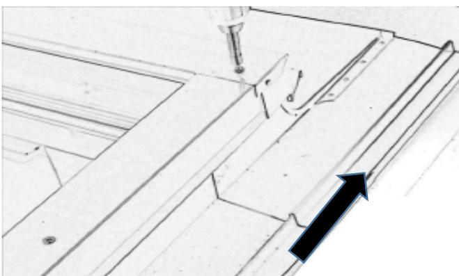
7. Applicare le due fascette di spugna in dotazione nella nervatura del raccordo. La punta va rivolta verso l'alto per l'appoggio delle tegole.
